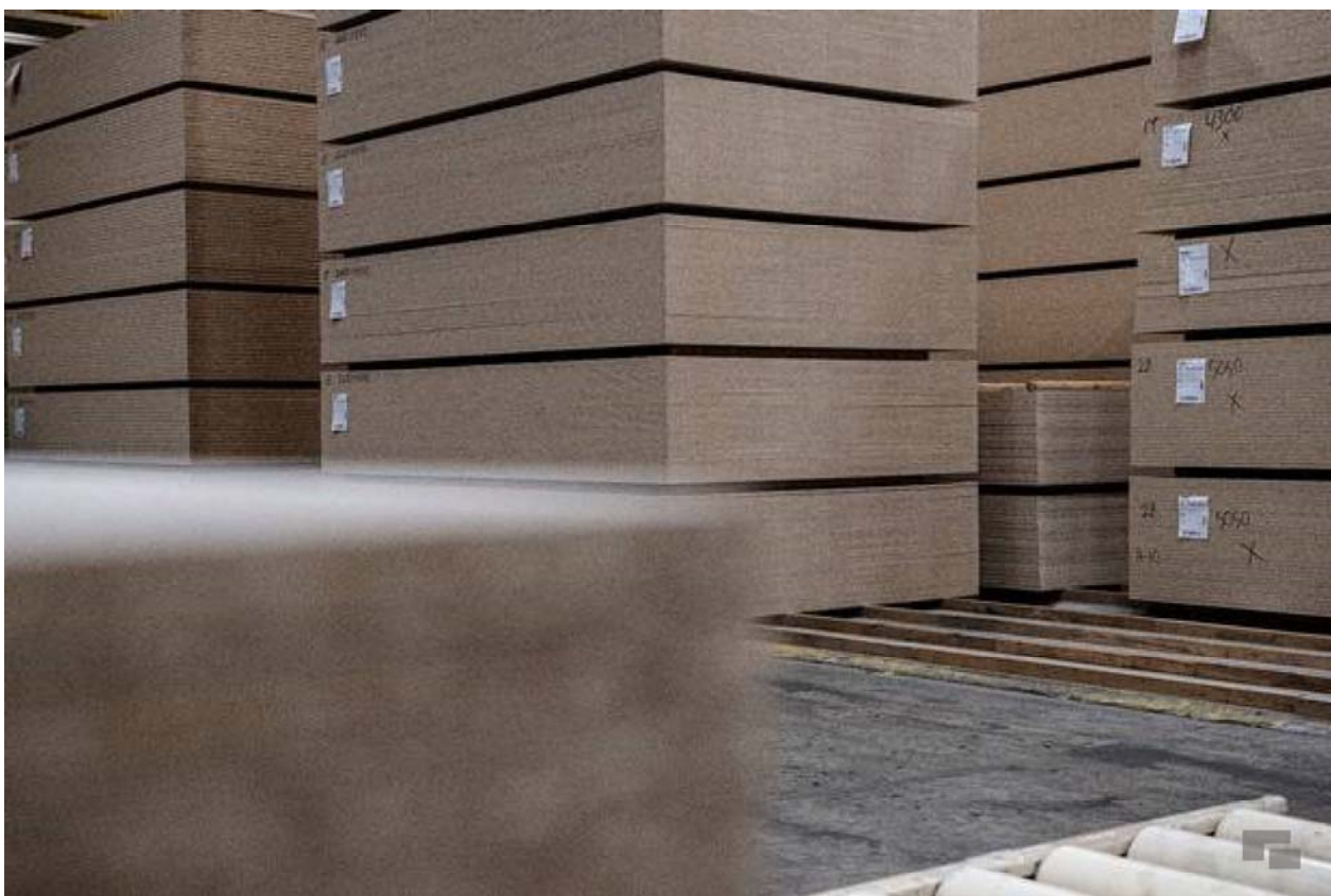
Her ligger den færdige vare: spånplader i læssevis, som er klar til at blive snedkereret til fx køkkener, garderober, skriveborde eller gulve. Pladerne er fabrikeret af 90 procent træ og 10 procent lim. Foto: Casper Dalhoff
